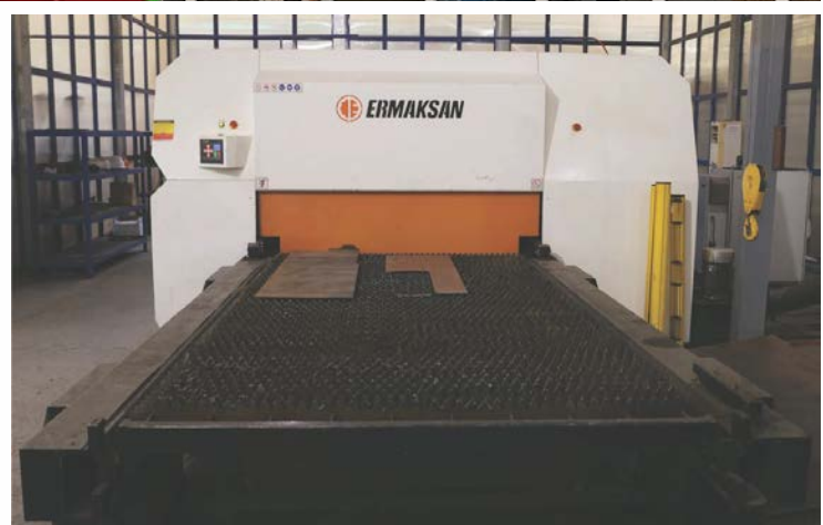
12. Станок лазерной резки с ЧПУ Fibermak SM-2000 компании ERMAKSAN
