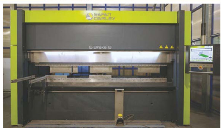
11. Листогибочный пресс с ЧПУ (производитель - компания «Safan Darley»)
