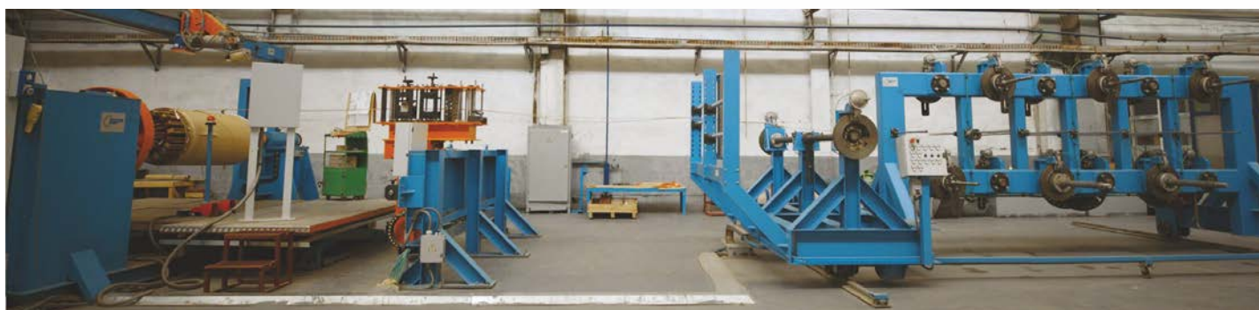
03. Горизонтальные намоточные станки VFOP-1600, VFOP-2500 (производитель - компания «BF»)
